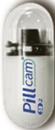
1 Dünndarmkapsel und Aufnahmerekorder
